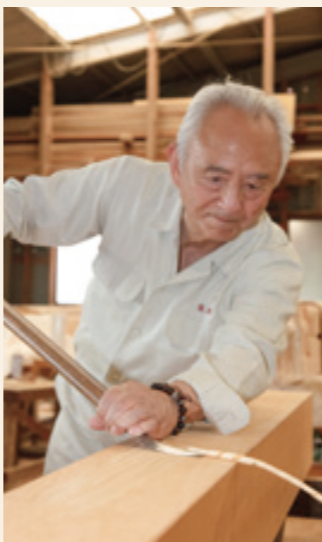
やり鉋かけ。伝統的な大工道具の一つであるやり鉋は、表面がざざ波模様仕上がる特性を持つ
